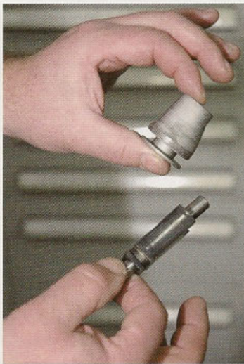
Zwei Raumnocken, oben für Serien-, unten für Rennsportanwendungen
